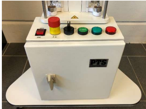
Foto nr 2: schakelkast
